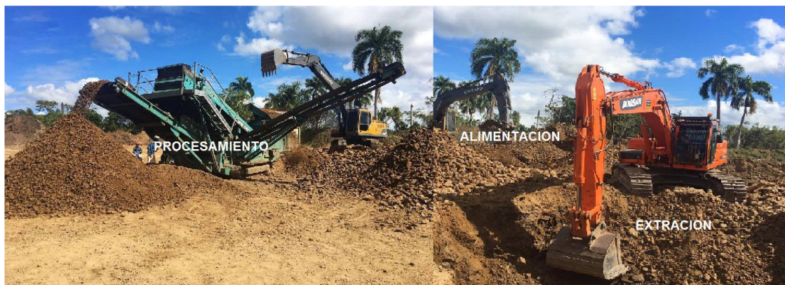
Esquema visual del proceso de operación combinado Retro–Zaranda-Cargador
